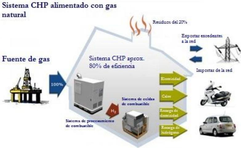
Figura 7.15. Sistema combinado de calor y potencia (CHP) para aplicaciones estacionarias
