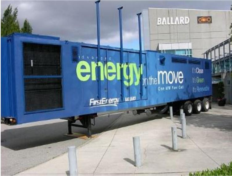
Figura 7.1. Ejemplo de sistema de suministro de potencia eléctrica basado en celdas de combustible
