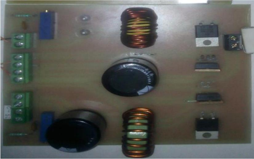
Figura 3.21. Circuito con el convertidor Buck y Boost.
