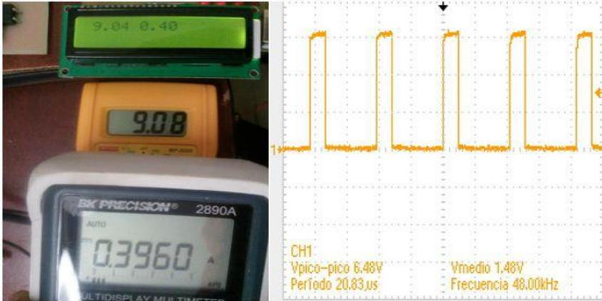
Figura 3.25 Lectura a través del multímetro y PIC lado izquierdo, salida PWM al 25% lado derecho.
