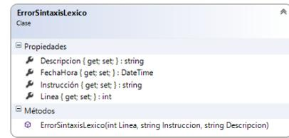
Fig. 2: Diagrama UML de la clase que define un error encontrado en el proceso de compilación
