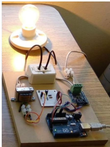
Figura 5.10 Medición de energía de una lámpara incandescente.
