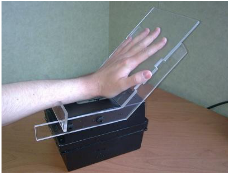
Figura 3.26: Dispositivo utilizado para adquirir imágenes de la palma y muñeca de la mano.
