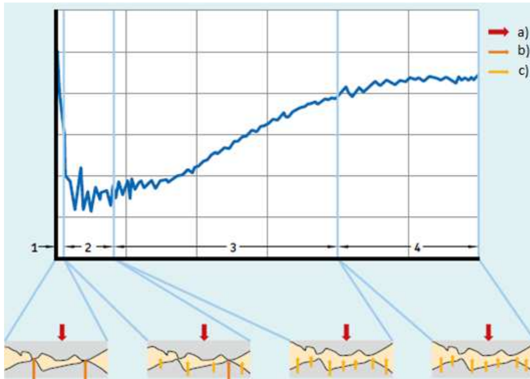
Fig. 3.16 Momento de fricción con respecto al tiempo: a) Carga, b) carga compartida llevada por asperezas, c) Carga compartida llevada por película lubricante
