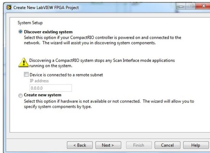
Figura A.3: Ventana para encontrar dispositivos FPGA LabVIEW 2012
