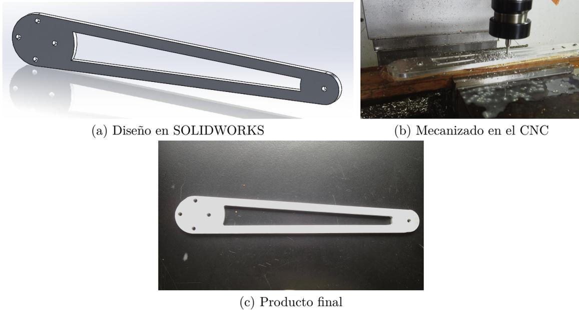
Figura 5.15: Etapas de fabricación de un brazo del RDDCA
