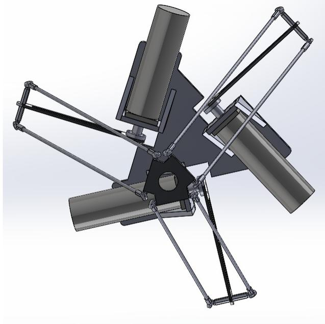
Figura 5.3: Mecanismo del RPD ensamblado totalmente
