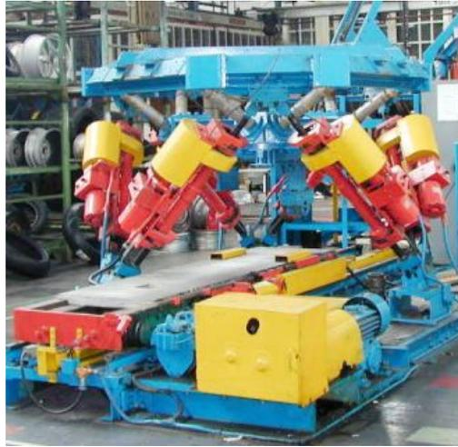
Figura 1.3: Plataforma de Gough [1.6]
