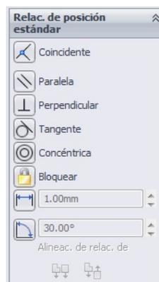
Figura 5.2: Herramientas de posicionamiento estándar para ensamblajes
