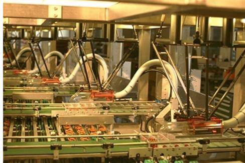
Figura 1.7: Robot Delta de la empresa Demarex en la industria alimenticia [1.3]
