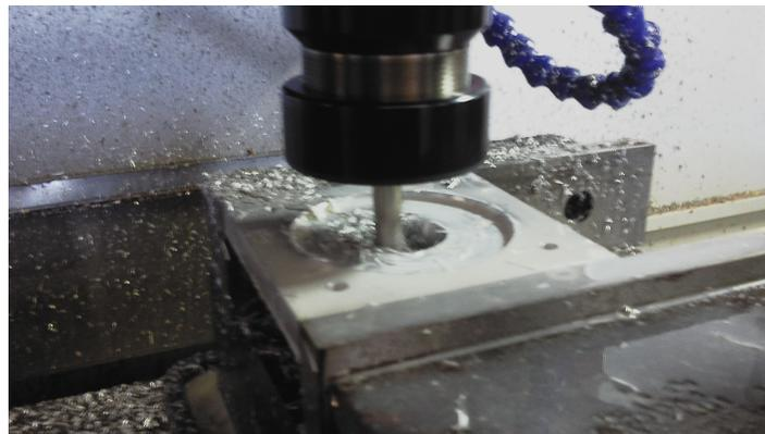
Figura 5.14: Maquinado de pieza sujeta-motor
