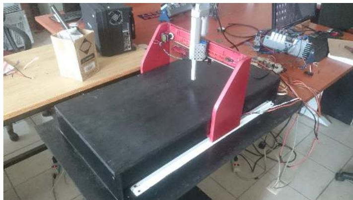
Figura 4.4: Prototipo del robot cartesiano.
