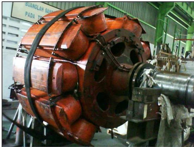
**Fig. 1.6** Rotor de polos salientes [1.12]
