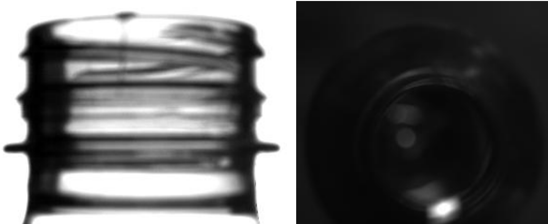
Figura 5.27 Vista lateral y vista superior de una botella que presenta una grieta
