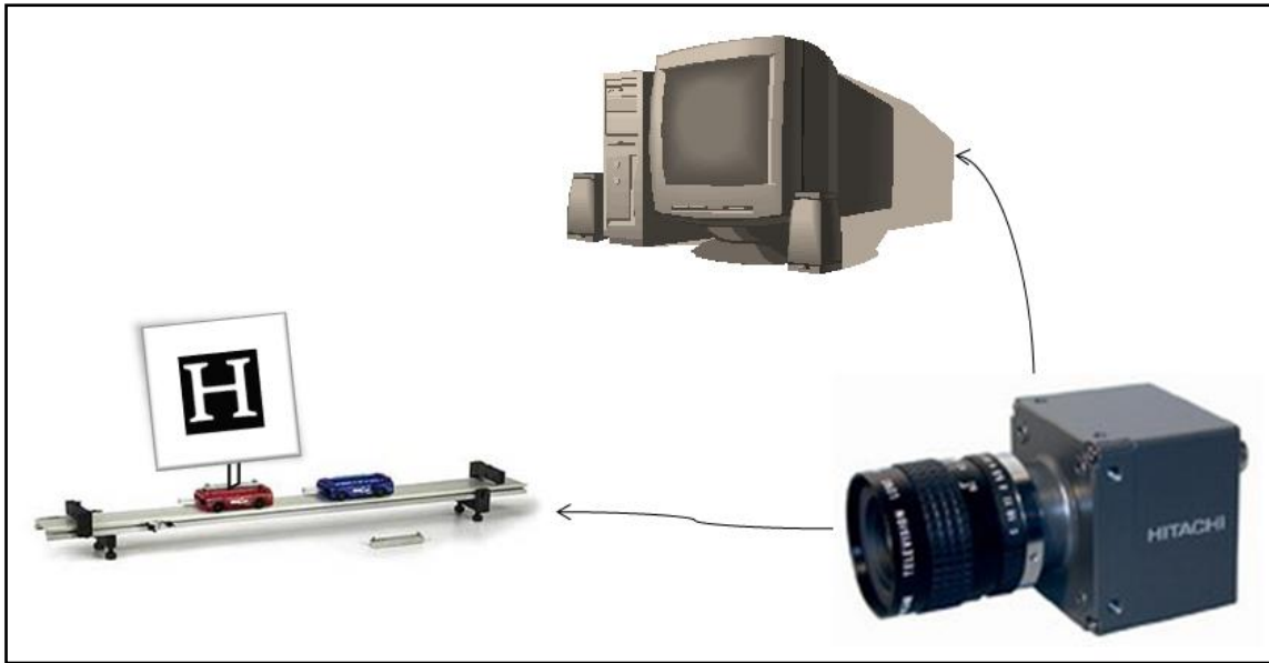
Figura 5.2 Diagrama del sistema óptico – digital y del sistema de simulación de movimiento lineal, utilizado para la realización del experimento.
