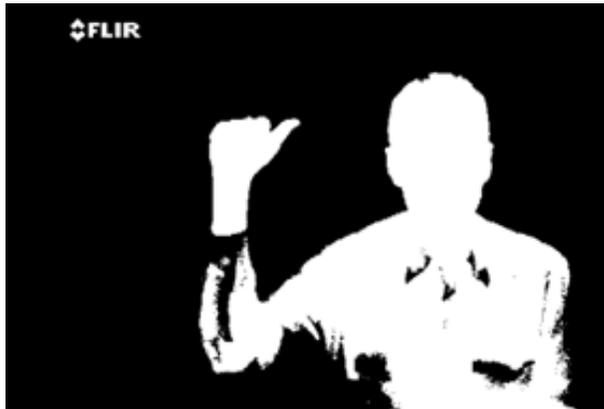
figura 4.22: Imagen de la cámara térmica binarizada con el umbral  $[180, 255]$  obtenido por medio del histograma.
