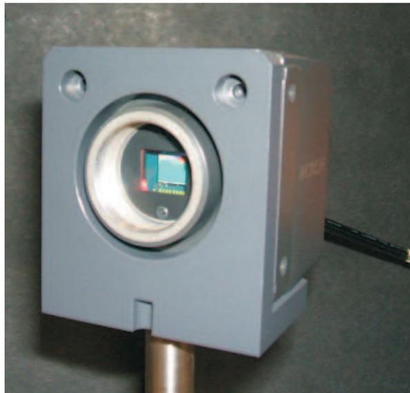
Figura 3.3: Cámara CCD
