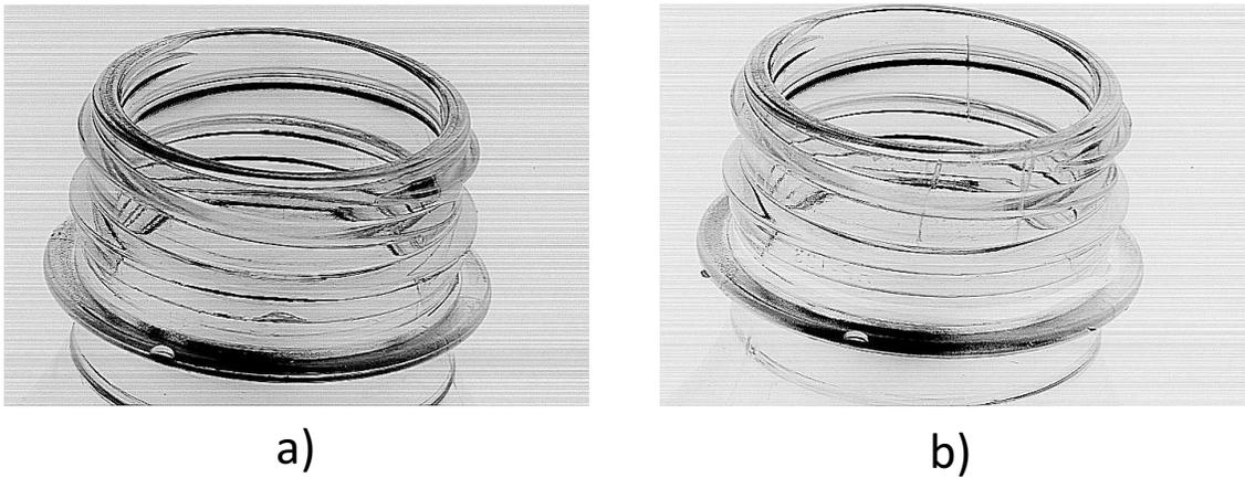
Figura 3.21: Imágenes de la botella de la Figura 3.18 realizadas usando un filtro Laplaciano. a) sin defecto, b) con defecto.
