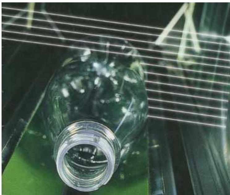
Figura 1.6: Clasificación de botellas por el tipo de material con el que fueron fabricadas usando técnicas de espectroscopía .
