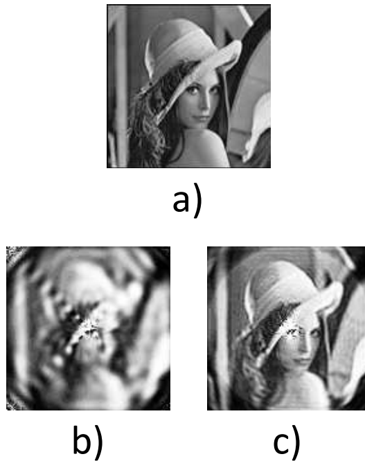
Figura 3.15: Imágenes en escala de gris de tamaño 128 \times 128 px reconstruidas con momentos a) Armónicos Seno con n = l = 128 , b) Jacobi-Fourier con \alpha = \beta = 4 y n = l = 21 y c) Bessel con n = l = 47 .
