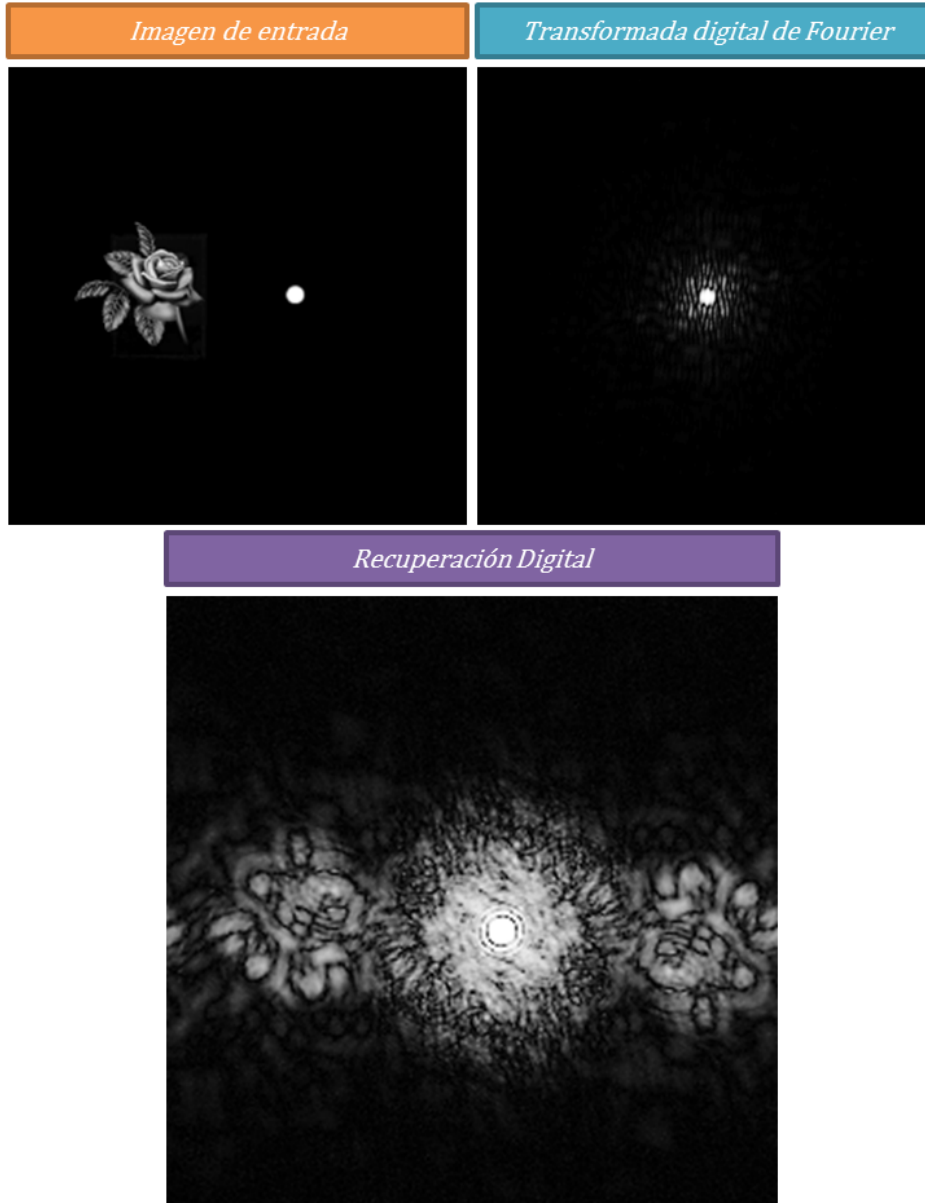
Figura 3.50: Recuperación de intensidades mediante el algoritmo de Fresnel a partir de un filtro digital de Fourier
