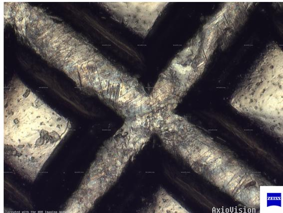
Figura 5.25: Imagen fusionada correspondiente a una llave de aluminio empleando la Distancia Euclidiana + Kirsch
