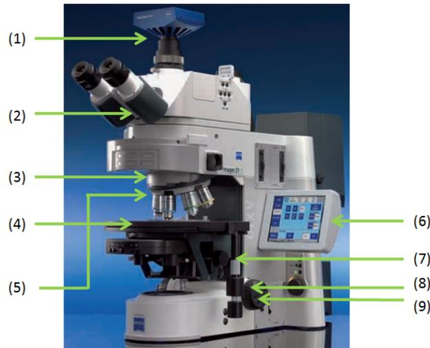
Figura 2.10: Microscopio Axio Imager M1 utilizado para registrar las imágenes de esta investigación
