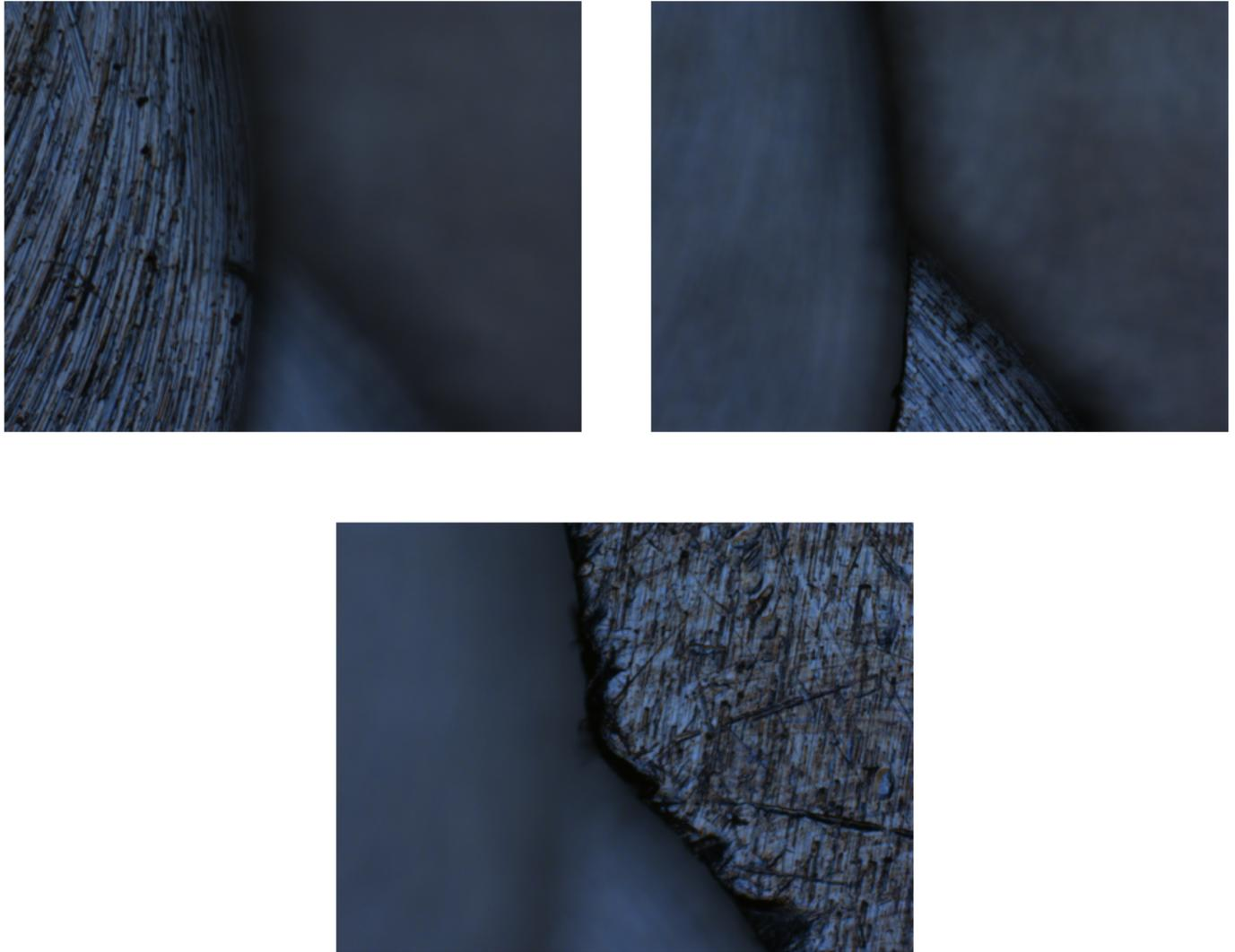
Figura 2.12: Muestra de grafito con tres planos de enfoque, amplificación de  $10\times$ , N.A. de 0,30 en iluminación de campo brillante.
