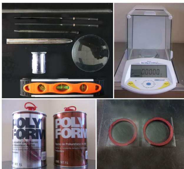
Figura 3.1: Instrumentación empleada para la fabricación de objetos imitadores de tejido. Primer fila, de izquierda a derecha: Instrumentos del laboratorio de Química (dos agitadores, dos pipetas de Pasteur de 1 ml, una espátula, un vaso de precipitado de 30 ml, un reloj de vidrio, un nivel de mano) empleados para realizar la mezcla con la que se elaboraron los phantoms, balanza analítica Adam PW254. Segunda fila, de izquierda a derecha: barniz de poliuretado A-218 y catalizador para barniz de poliuretano A-218, dos moldes de 10 ml de capacidad elaborados con una lámina de cristal y un anillo de goma.
