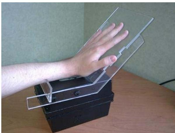
Figura 4.31: Dispositivo utilizado para adquirir imágenes de la palma y muñeca de la mano.
