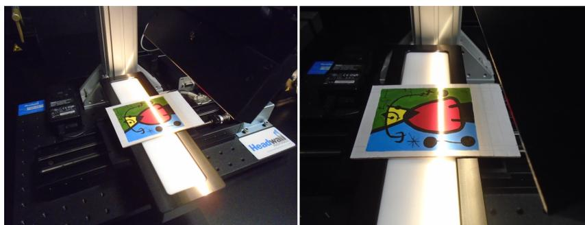
Figura 5.5: Proceso de registro de una imagen hiperespectral mediante la cámara hiperespectral Headwall. Observe que el registro se hace línea por línea con el movimiento de la platina.
