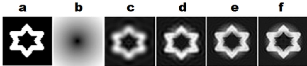
Figura 2.11: a) Imagen Original, b), c), d), e), f) Reconstrucciones de la imagen original usando JFMs con ordenes 0,10, 20, 30 y 40 respectivamente.
