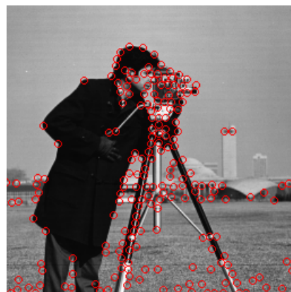
Figura 2.19: Aplicación del método de Harris y del método de Shi y Tomasi para la detección de esquinas a la imagen del cameraman .
