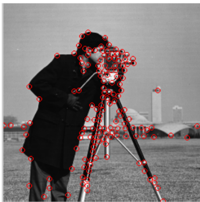
Figura 2.19: Aplicación del método de Harris y del método de Shi y Tomasi para la detección de esquinas a la imagen del cameraman .
