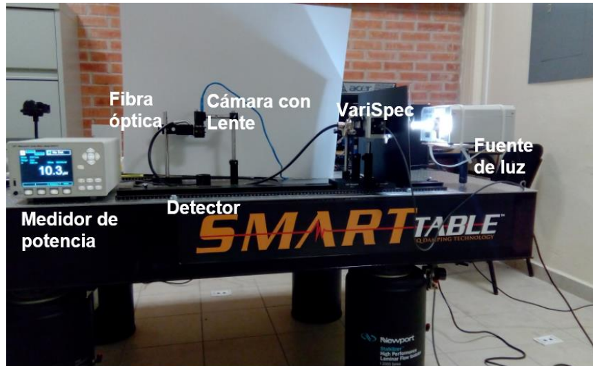
Figura 3.13: Fotografía del arreglo experimental general para la medición del perfil del haz proporcionado al final de la fibra óptica, usado para la toma de imágenes multispectrales.
