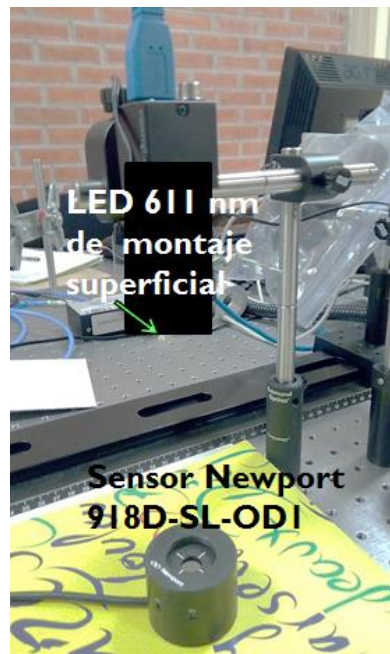
Figura 4.8: LED de montaje superficial colocado en un costado de la lente de la cámara, para servir de fuente de iluminación.
