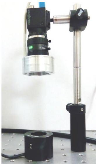
Figura 4.4: Anillo de LEDs sobre la cámara monocromática a 11.5 cm para la caracterización espectral.
