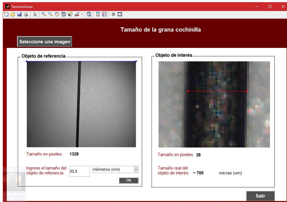
Fig. 4.20 Comprobación del programa para calcular el tamaño de la grana cochinilla, usando como objeto de estudio a una puntilla de grafito de 0.7 mm.
