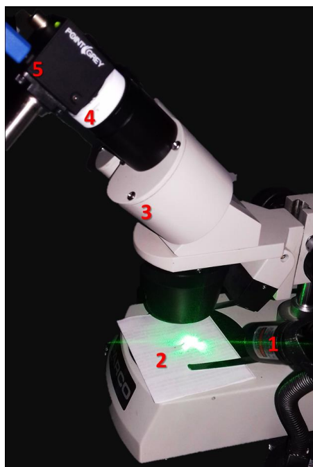
Fig. 3.4 Arreglo óptico experimental para observar fluorescencia microscópicamente, se compone principalmente de (1) una fuente de luz láser (532 nm), (2) muestras de grana cochinilla de diferentes tamaños, (3) un microscopio simple sin ocular, (4) un filtro pasa bandas (660 nm) y (5) una cámara CMOS a color sin lente.
