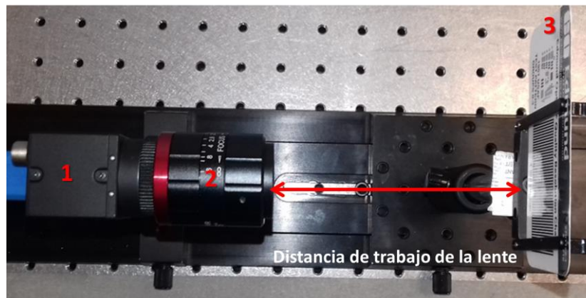
Fig. 4.4 Arreglo óptico para realizar la captura de las imágenes macroscópicas del patrón USAF-1951. El arreglo está compuesto por: el conjunto (1) cámara a color CMOS y (2) la lente Edmund Optics, (3) y el patrón de resolución USAF-1951.
