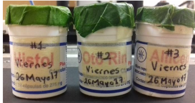
Fig. 5.8 Porta-muestras elaborados a partir de envases de medicamento.
