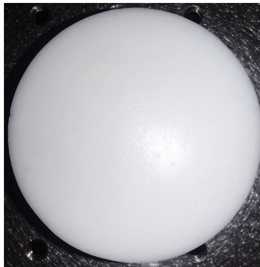
Fig. 5.3 Barra de teflón® utilizada como estándar de reflectancia además del estándar WS-1 (Ocean Optics™).
