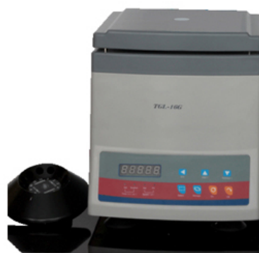
Figura 3.14: Centrifugadora de alta velocidad con pantalla programable, imagen de referencia tomada de (Biocotek, 2017)
