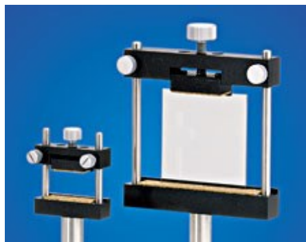
Figura 3.11: Abrazadera ajustable rectangular. Imagen de referencia tomada de (Edmund, 2017)
