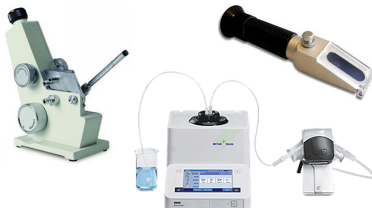
Figura 1.2: Dispositivos refractométricos para medir el índice de refracción de soluciones acuosas, refractómetro portátil, de Abbe y refractómetro digital (Toledo, 2017).
