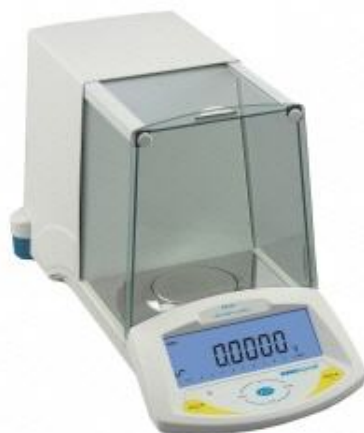
Figura 3.13: Balanza electrónica analítica digital, imagen de referencia tomada de (ADAM, 2017)
