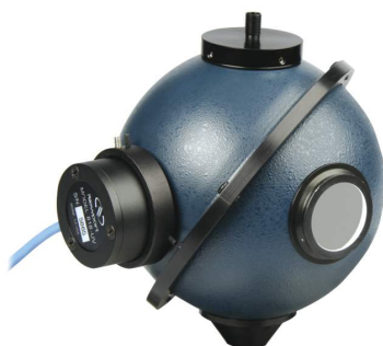
Figura 3.7: Esfera integradora de la firma Newport con sensor acoplado. Imagen de referencia tomada de (Newport, 2017d)
