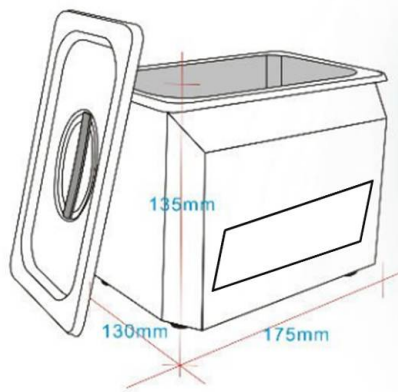
Figura 3.2: Esquema de tina ultrasonica.
