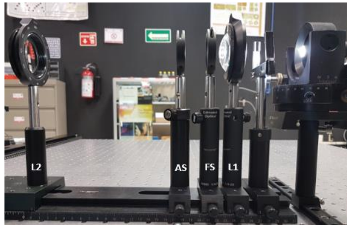
Fig. 4.7 Arreglo experimental iluminación Köhler.
