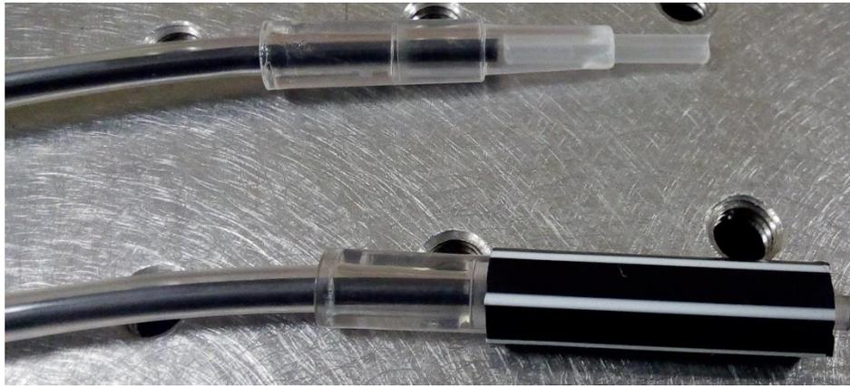
**Figura 3.3.** Extremo bifurcado de la sonda de fibras ópticas.
