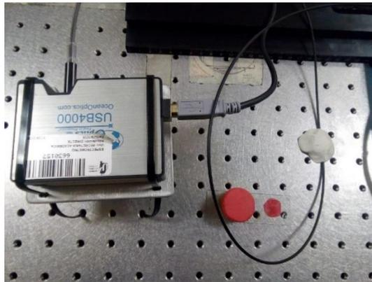
**Figura 3.8.** Espectrómetro USB 4000 y muestra de plastilina utilizada.
