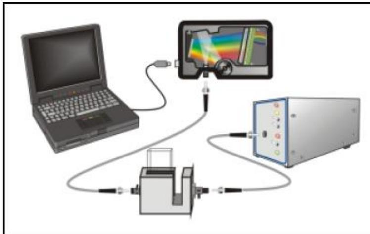
**Figura 2.2.** Configuración típica para la obtención de la absorbancia de una muestra. Manual Ocean Optics SpectraSuite
