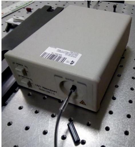
**Figura 3.10.** Fuente de luz Newport LSM-T-S conectada al extremo de la sonda de fibra.
