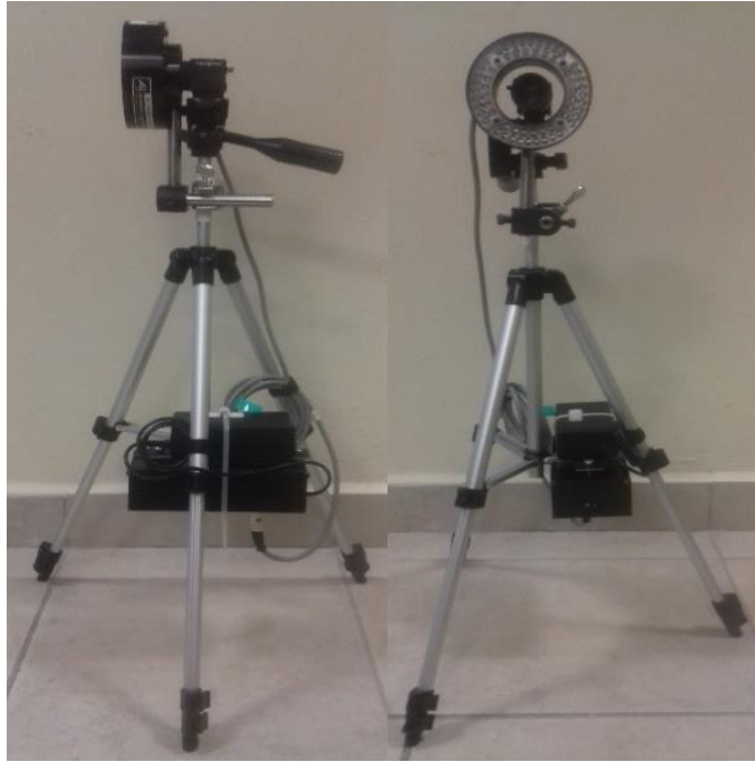
Figura 4.9. Prototipo óptico-mecánico para la generación de imágenes en voluntarios sin cubierta.
