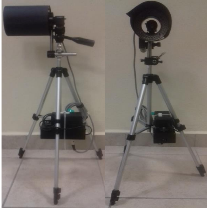
Figura 4.10. Prototipo óptico-mecánico para la adquisición de imágenes digitales en zonas de riesgo en voluntarios con cubierta.
