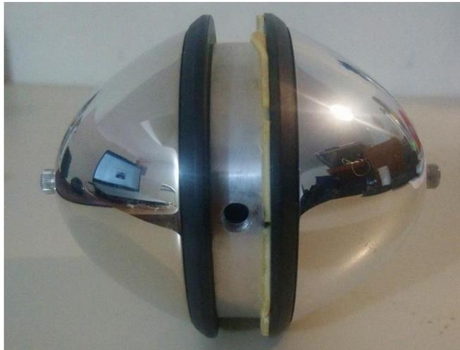
*Figura 13 Espejos parabólicos usados en el arreglo propuesto.*
