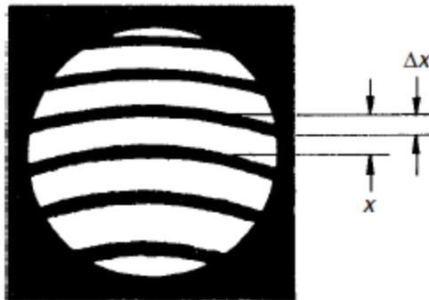
Figura 1 Evaluación de errores por interferencia en una superficie de prueba plana pulida [11].
