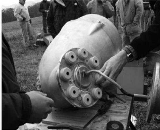
**Figura 34.** Colocación de aisladores de vibración [8].
