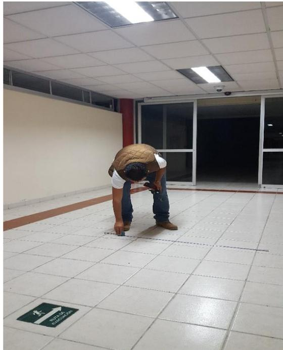
*Figura 4.3 Medición de iluminancia en pasillos con referencia en la NOM-025-STPS 2008*
