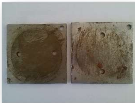
[Figura 12] Placas de acero A-53 habilitadas
