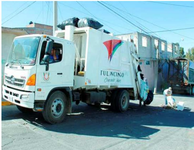
Figura 3.1: Servicio de recolección de residuos, recolector compactador carga trasera de dos ejes.
