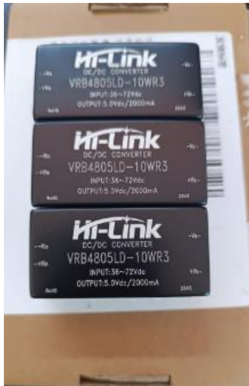
Fuente de Voltaje DC/DC
