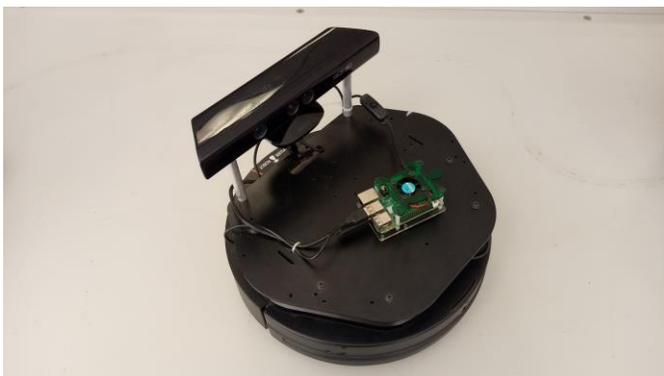
**Kokubi Turtlebot** modelo II de acceso abierto propuesto por Willow Garage utilizado como una plataforma móvil de bajo coste, para entornos educativos e investigación. Consiste en una base Yujin Kobuki, un paquete de baterías de 2,200 mAh, un sensor Kinect, una computadora portátil Asus 1215N con un procesador de doble núcleo, cargador rápido, base de carga y un kit de montaje de hardware que une todo y agrega sensores futuros
