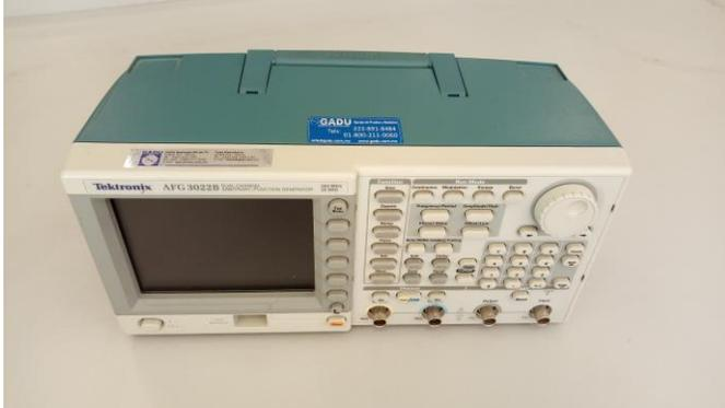
**Generador de funciones/doble canal arbitrario** modelo AFG3022b de la compañía Tektronix, Generador de Funciones DDS Arbitrario de 25 MHz; 2 Canales, Tiempo de Subida:  $\leq 18\text{nS}$ ; Interfaces USB, GPIB y LAN cuenta con pantalla a color de 5,6 para mejor visualización de las configuraciones y de las formas de onda.
