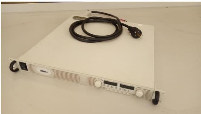
**Fuente de Alimentación DC programable** modelo GEN50-30 de la compañía Genesys utilizado para la generación de voltaje y corriente constante con configuración en serie o en paralelo, de 0 a 50 V, corriente de 0-30A y potencia de 1500W. Tiene una precisión de 2.5%, cuenta con una pantalla y perillas para ajuste e interfaz de RS-232 y RS-485.
