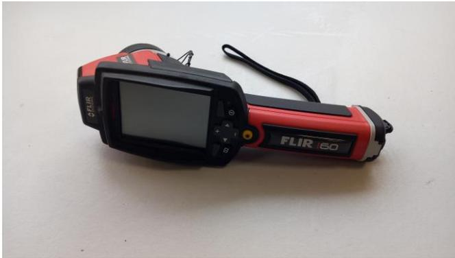
**Cámara de imágenes térmicas infrarrojo con láser pip** modelo FLIR I60 de la compañía Flir Systems utilizado para la generación de imágenes térmicas con resolución de 180 x 180 píxeles. El rango de temperatura es de  $-20^{\circ}\text{C}$  a  $350^{\circ}\text{C}$  con una sensibilidad de  $0.1^{\circ}\text{C}$  y apuntador láser. Cuenta con una pantalla de 3.5 pulgadas.
