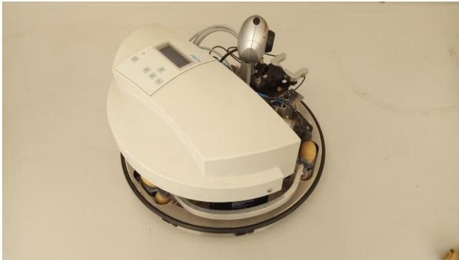
**Plataforma móvil** modelo Robotino de la compañía FESTO. Es una plataforma robótica móvil para la investigación y la educación. Equipado con una unidad omnidireccional y con sus sensores, interfaces y extensiones específicas, es una plataforma flexible: para la programación de aplicaciones individuales, los lenguajes y sistemas de programación más importantes están disponibles.
