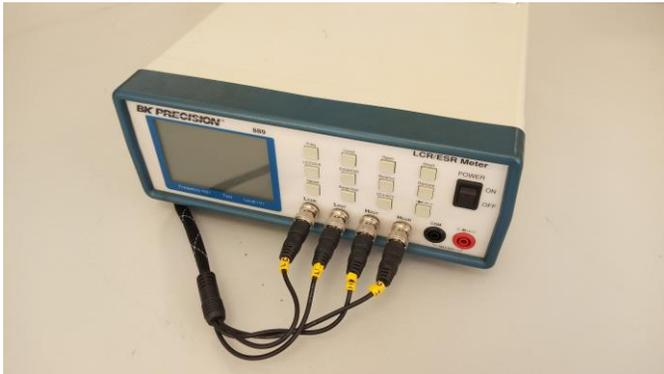
**Probador LCR/ESR** modelo 889 de la compañía BK PRECISION se usa para medir inductores, capacitores y resistencias con una precisión de 0.2%, también mide voltajes A/DC y continuidad de diodos y audible. Tiene una pantalla LCD dual con frecuencias de prueba de 100Hz, 120Hz, 1kHz, 1kHz, 100kHz o 200kHz y niveles seleccionables de 0.05, 0.25 o de 1 Vrms.
