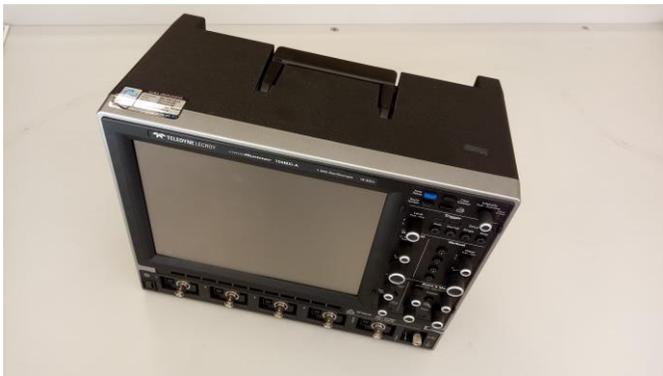
**Osciloscopio** modelo waveRunner 104MXi-A de la compañía Teledyne Lecroy, DSO de 1 GHz, con frecuencia de muestreo de 5 GS / s, 4 canales, 12.5 Mpts / Ch Cuenta con modos de visualización rápida, parámetros de medición y decodificaciones en serie La depuración avanzada, el análisis multidominio y el análisis WaveShape son posibles con herramientas exclusivas de WaveRunner Xi
