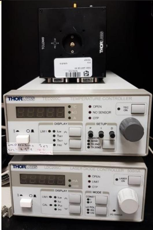
**Láser de estado sólido** con sus respectivos controladores de corriente y temperatura de la marca *Thorlabs*. Este láser emite con una longitud de onda de  $532 \text{ nm}$  y una potencia máxima de  $100 \text{ mW}$
