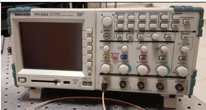
**Osciloscopio digital** modelo TPS 2024 de la compañía *Tektronix* usados visualizar señales digitales y analógicas
