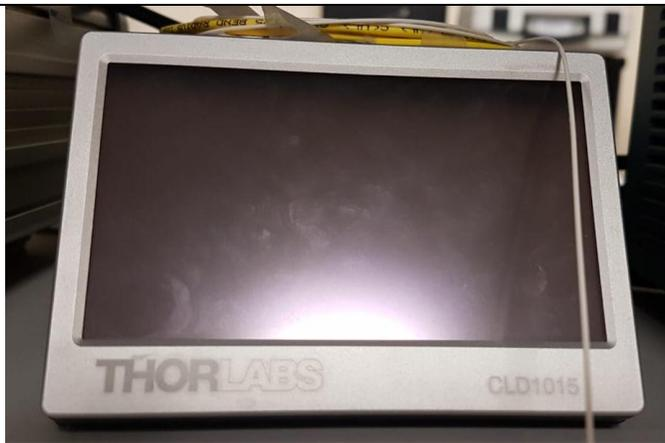
**Láser tipo mariposa** acoplado a fibra óptica que emite a una longitud de onda de  $1550 \text{ nm}$  con su respectivo controlador de corriente y temperatura marca *Thorlabs*.
