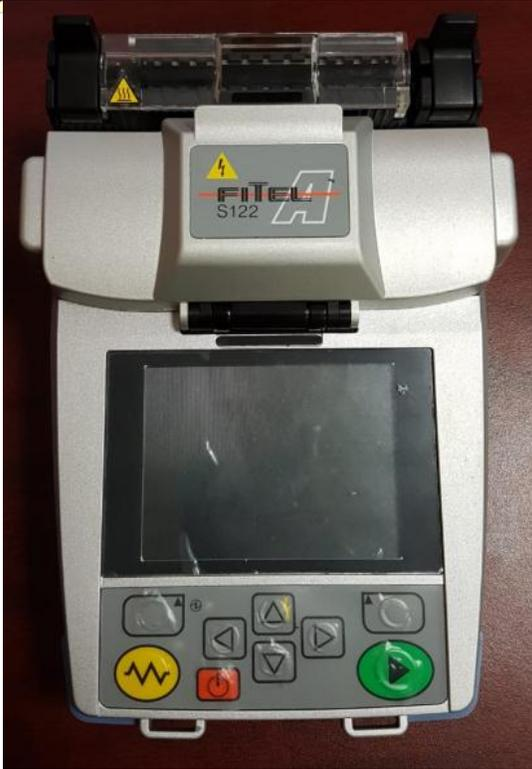
**Empalmadora para Fibra Óptica** modelo S1200 de la compañía FIBEL, necesaria para llevar acabo la fusión entre fibra ópticas.
