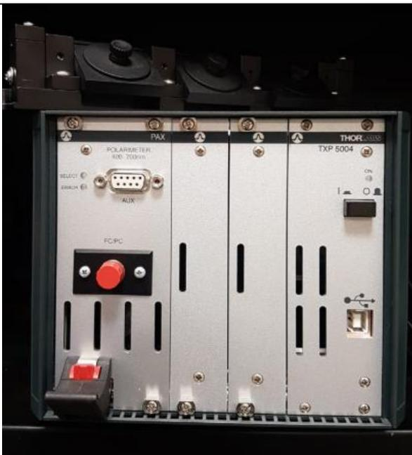
**Polarímetro** modelo TXP 5004 de la compañía *Thorlabs*. Trabaja en la región de los  $400$  a  $700 \text{ nm}$  y tiene una entrada FC. Es indispensable para conocer el estado de polarización de la luz que viaja a través de las fibras ópticas.
