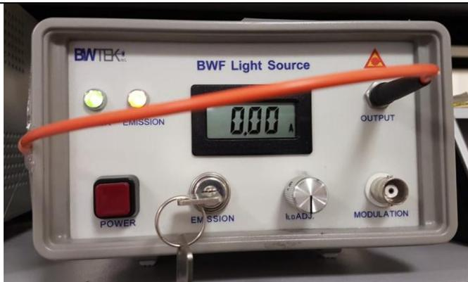
**Diodo láser** de estado sólido, con su respectivo controlador de corriente de la marca BWTEK que emite a una longitud de onda de  $454 \text{ nm}$  y una potencia máxima de  $500 \text{ mW}$ . Este láser está acoplado a una fibra óptica
