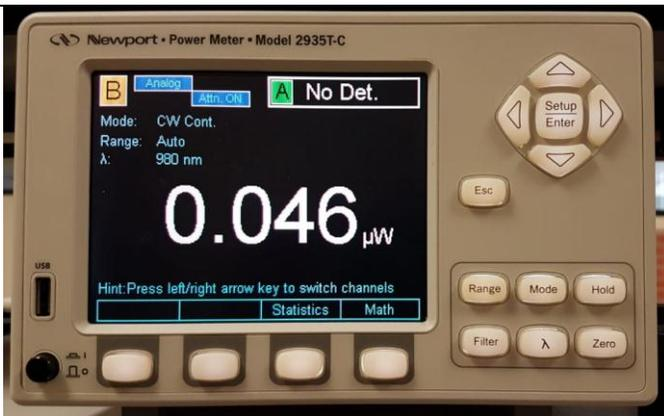
**Medidor de potencia** modelo 2935T-C de la compañía Newport, el cual es usado para medir la potencia de fuentes de luz. Además, cuenta con diferentes detectores para trabajar con diversas longitudes de onda
