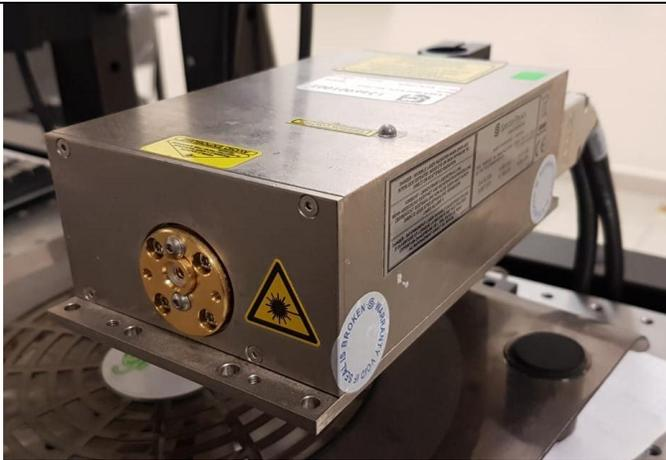
**Láser pulsado** modelo Explorer de la compañía *Spectra-Physics*, emite pulsos del orden de 5-100 ns y opera en la región visible. Este láser es útil en la caracterización de muestras, etc.
