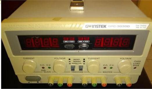
**Fuente de Alimentación DC** modelo GPC-3030D de la compañía GW Instek utilizado para la generación de voltaje y corriente constante, de 0 a 30 V, corriente de 0-3A con una salida ajustable y dos salidas fijas. La protección de sobrecarga y polaridad inversa mantiene la serie GPC y sus cargas a salvo de condiciones inesperadas. Cuenta con una pantalla y perillas para ajuste.
