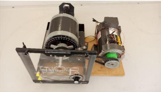
**Electrodinómetro** modelo Lab-Volt 8911-12 de la compañía FESTO. Consiste de un rotor de jaula de ardilla instalado en un estator excitado por corriente continua. La carga mecánica se logra al aumentar la corriente de campo del estator, que genera corrientes parásitas en el rotor accionado. El estator gira contra un resorte helicoidal para oponerse al par de frenado.
