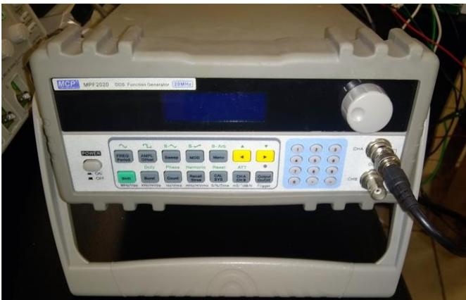
**Generador de funciones/doble canal** modelo MPF2020 de la compañía MCP lab electronics, Generador de Funciones DDS de 20 MHz; 2 Canales, con 32 tipos de formas de onda. Con pantalla lcd de 3.5 pulgadas para mejor visualización de las configuraciones. Interfaz RS232.
