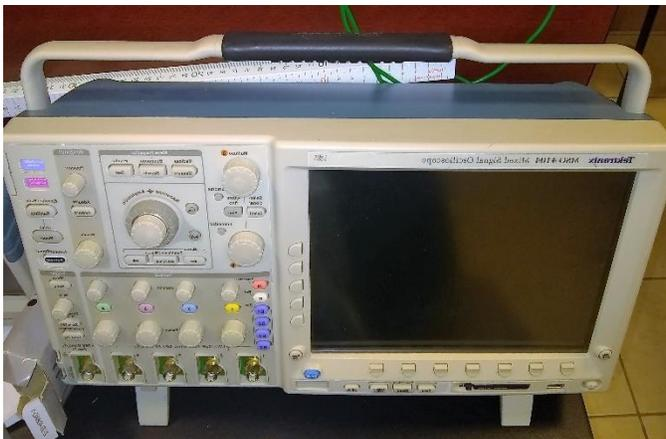
**Osciloscopio de señal mixta** modelo MSO 4104 de la compañía Tektronix, MSO/MDO de 1 GHz, con frecuencia de muestreo de 5 GSPS, 4 canales, 12.5 Mpts / Ch Cuenta con modos de visualización rápida, parámetros de medición y analizador de espectros y contador DVM/frecuencia. Es el único instrumento que proporciona adquisición simultánea y sincronizada de analógico, digital y espectro, ideal para incorporar comunicaciones inalámbricas (IoT) y solución de problemas de EMI.
