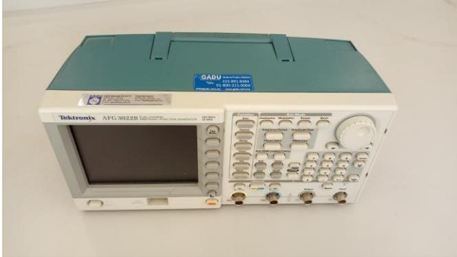
**Generador de funciones/doble canal arbitrario** modelo AFG3022b de la compañía Tektronix, Generador de Funciones DDS Arbitrario de 25 MHz; 2 Canales, Tiempo de Subida:  $\leq 18\text{nS}$ ; Interfaces USB, GPIB y LAN cuenta con pantalla a color de 5,6 para mejor visualización de las configuraciones y de las formas de onda.
