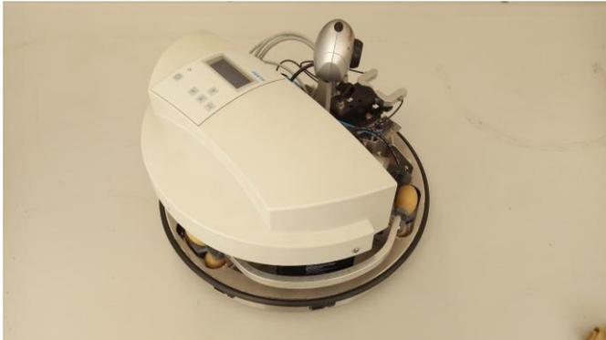
**Plataforma móvil** modelo Robotino de la compañía FESTO. Es una plataforma robótica móvil para la investigación y la educación. Equipado con una unidad omnidireccional y con sus sensores, interfaces y extensiones específicas, es una plataforma flexible: para la programación de aplicaciones individuales, los lenguajes y sistemas de programación más importantes están disponibles.
