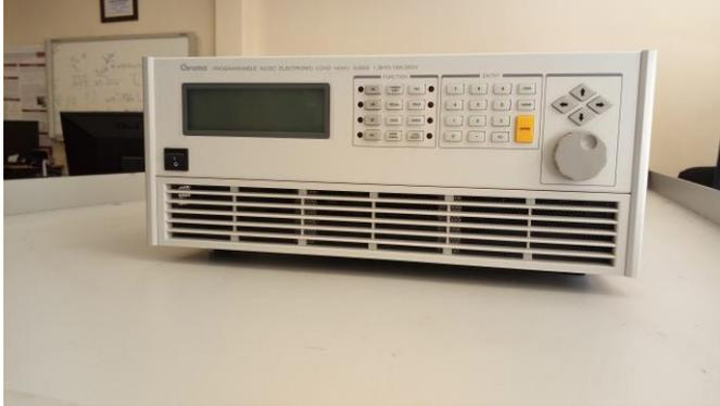
**Carga electrónica programable AC/DC** modelo 63800 de la compañía Chroma, puede simular una variedad de condiciones de carga bajo un factor de cresta alto y factores de potencia variables con compensación en tiempo real, incluso cuando la forma de onda del voltaje está distorsionada. Tiene un rango de potencia de 1800W/3600W/4500W, y de voltaje de 50V – 350Vrms. Interfaces GPIB and RS232
