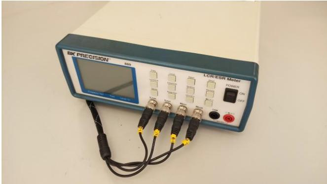
**Probador LCR/ESR** modelo 889 de la compañía BK PRECISION se usa para medir inductores, capacitores y resistencias con una precisión de 0.2%, también mide voltajes A/DC y continuidad de diodos y audible. Tiene una pantalla LCD dual con frecuencias de prueba de 100Hz, 120Hz, 1kHz, 1kHz, 100kHz o 200kHz y niveles seleccionables de 0.05, 0.25 o de 1 Vrms.
