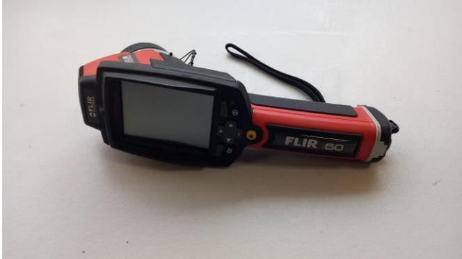
**Cámara de imágenes térmicas infrarrojo con láser pip** modelo FLIR I60 de la compañía Flir Systems utilizado para la generación de imágenes térmicas con resolución de 180 x 180 píxeles. El rango de temperatura es de -20°C a 350°C con una sensibilidad de 0.1°C y apuntador láser. Cuenta con un pantalla de 3.5 pulgadas.
