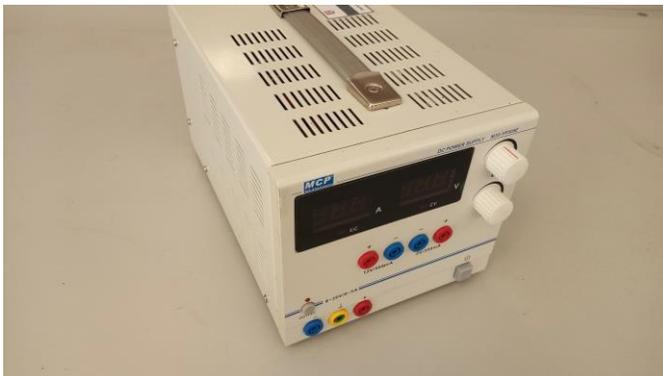
**Fuente de Alimentación DC** modelo M30-YP305E de la compañía MCP lab electronics utilizado para la generación de voltaje y corriente constante, de 0 a 30 V, corriente de 0-5A con una salida ajustable y dos salidas fijas. Tiene una precisión de 2.5%, cuenta con una pantalla y perillas para ajuste.
