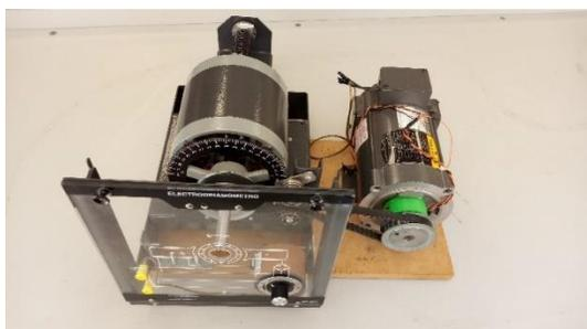
**Electrodinómetro** modelo Lab-Volt 8911-12 de la compañía FESTO. Consiste de un rotor de jaula de ardilla instalado en un estator excitado por corriente continua. La carga mecánica se logra al aumentar la corriente de campo del estator, que genera corrientes parásitas en el rotor accionado. El estator gira contra un resorte helicoidal para oponerse al par de frenado.
