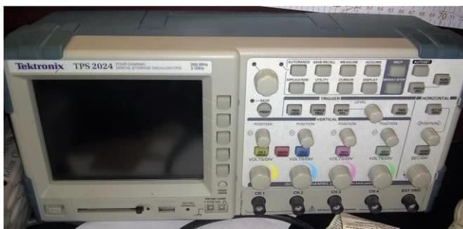
**Osciloscopio de señal mixta** modelo TPS 2024 de la compañía Tektronix, MSO/MDO de 200 MHz, con frecuencia de muestreo de 2 GSPS, 4 canales. Pantalla a color con escala automática para ajustar las formas de ondas en la pantalla del osciloscopio y cambiar puntos de prueba sin reiniciar el osciloscopio. Mediciones de potencia trifásica y mediciones flotantes y a tierra multicanal en hasta cuatro canales simultáneamente, hasta depuración de circuitos de control.
