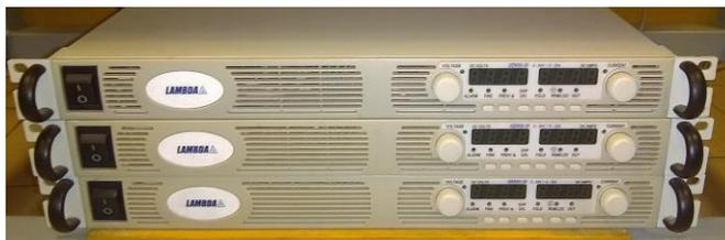
**Fuente de Alimentación DC programable** modelo GEN50-30 de la compañía Genesys utilizado para la generación de voltaje y corriente constante con configuración en serie o en paralelo, de 0 a 50 V, corriente de 0-30A y potencia de 1500W. Tiene una precisión de 2.5%, cuenta con una pantalla y perillas para ajuste e interfaz de RS-232 y RS-485.
