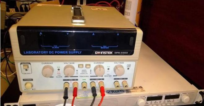
**Fuente de Alimentación DC** modelo GPS-3303 de la compañía GW Instek utilizado para la generación de voltaje y corriente constante, de 0 a 30 V, corriente de 0-3A con una salida ajustable y dos salidas fijas. Regulación de línea y carga de 0.01%, cuenta con una pantalla y perillas para ajuste.
