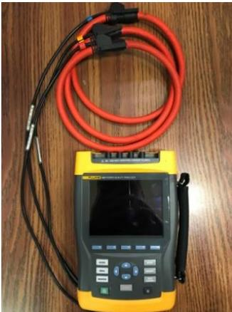
De la compañía FLUKE, modelo 435. Cuenta con 4 Entradas de tensión y 4 de corriente, capacidad de la memoria: 16MB. Mide la potencia eléctrica unificada (UPM), detecta y soluciona problemas en primer nivel de actuación, realizar un mantenimiento predictivo, hace análisis a largo plazo y estudios de carga.
