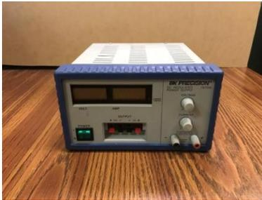
De la compañía BK Precision, modelo 1670A, línea de entrada de 120VAC, incluye modos de operación de voltaje constante y corriente constante. Las protecciones incluyen limitación de corriente, polaridad inversa, sobretensión y cortocircuito. El voltaje y la corriente de salida principal son monitoreados continuamente por dos medidores LCD digitales con resolución de 0.1 voltios y 0.01 A.
