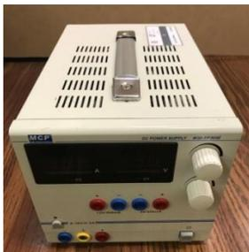
De la compañía MCP, modelo M30-YP305E. Cuenta con un voltaje de salida 0 - 30VDC, voltaje de entrada 0 - 5A, voltaje constante y corriente constante, serie y función de seguimiento paralelo, una salida ajustable y dos salidas fijas.
