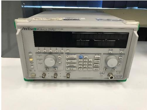
Instrumento que a partir de una frecuencia de referencia permite obtener un conjunto discreto de frecuencias, tratando de mantener en todos los casos las características de estabilidad de la frecuencia de referencia. La frecuencia de referencia puede ser interna a cristal o externa de superiores características, como ser un cristal calefaccionado de alta estabilidad, un oscilador disciplinado por GPS o un oscilador atómico.
