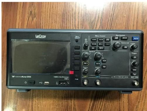
1. Dos canales, osciloscopio digital portátil para aplicaciones electrónicas como el diseño de productos, pruebas de datos Serial, disco, pruebas de automóvil y análisis de camión
