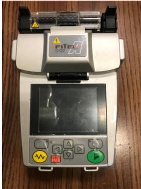
De la compañía FITEL, modelo S122. Ofrece una nueva generación de trabajo para cada aplicación de empalme de fusión de campo: FTTx, LAN, columna vertebral o instalaciones de largo recorrido.
