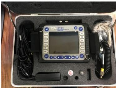
De la compañía CSI Technologies, modelo 2130. Recopila datos, análisis de vibraciones, alineación y equilibrio en una sola unidad, permite inspeccionar más equipos críticos de forma más rápida y precisa, tiene una amplia gama de herramientas disponibles para la toma de datos.
