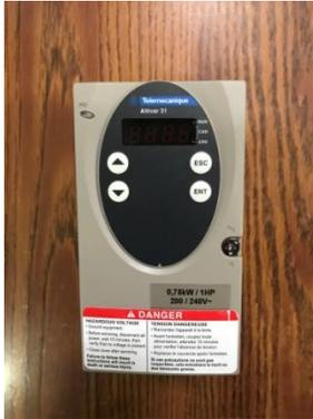
Modelo Altivar 31 de la compañía Telemecanique con filtro EMC clase A integrado, control de frenado, frenado dinámico, entrada de lógica de asignación múltiple, regulación PI, 16 velocidades pre ajustables. Conectividad abierta con sus puertos CANopen y Modbus integrados. Diseñado para motores asíncronos trifásicos de 0,18 a 15 KW. Módulos adecuados para diversas aplicaciones.
