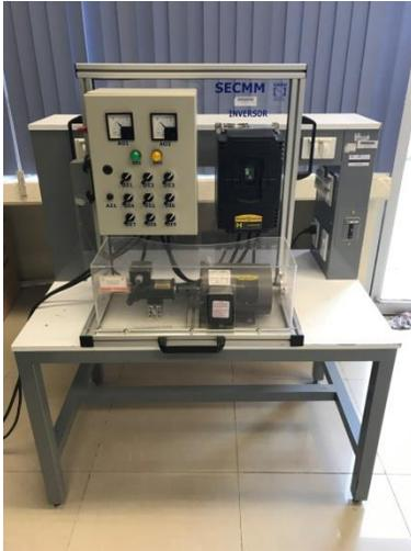
Motor con tacogenerador de la marca BALDOR VS1SP4150-1 150HP 460VAC Inversor Drive. Utiliza algoritmos de control de alto rendimiento para permitir el control de motores de inducción utilizando un método de control tradicional de V / Hz o un control vectorial sin sensor.
