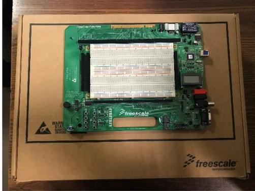
La placa de prototipo de microcontrolador se recomienda para su uso en múltiples cursos que van desde electrónica introductoria hasta aplicaciones de MPU y proyectos de diseño de alto nivel. La Junta de proyecto es la más adecuada para cursos basados en laboratorio que requieren que los estudiantes realicen un prototipo de circuito electrónico independiente o lógica de control de interfaz a una MPU.
