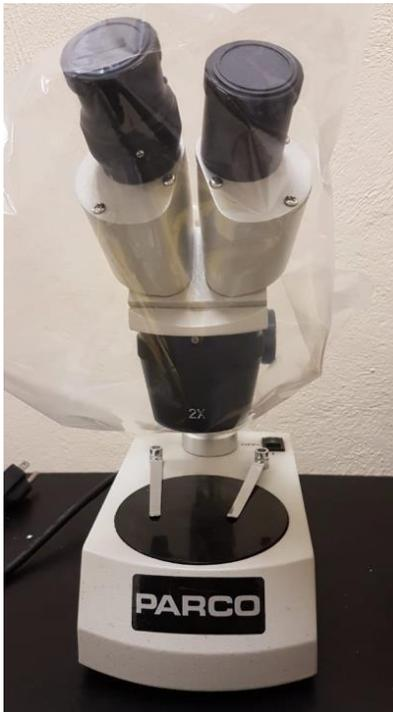
**Microscopio marca PARCO**, gran resolución, brillo y la claridad. Diseñado para la facilidad de uso y la simplicidad de operación. Cuenta con un binocular cabeza 45° que puede girar 180°, 15 x campo amplio oculares, puede trabajar con diferentes objetivos, entre ellos de 2x y 4x. Iluminación LED Superior e inferior para una fácil observación.
