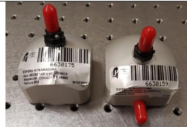
Esferas integradoras de la marca Newport, modelo SPH-REF-3 esfera recubierta en el interior por un material blanco que refleja y difumina la luz. Es usada para facilitar la operación de medición al eliminar las cualidades direccionales de la luz que se va a medir o del sensor del dispositivo mientras que se mantienen todas sus otras características.
