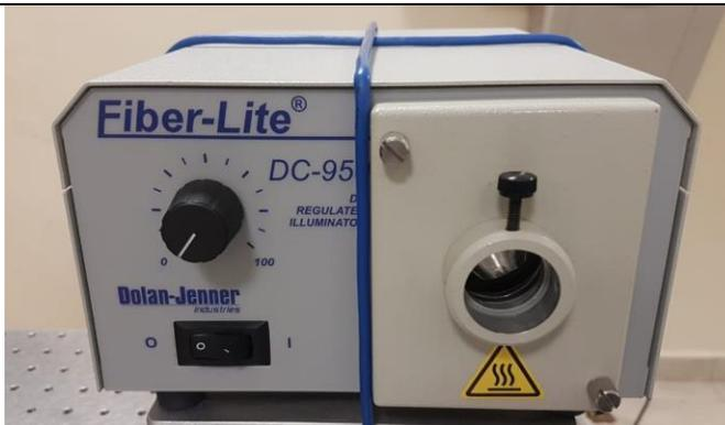
**Fuente de luz marca Dolan Jenner modelo Fiber-Lite DC-95** la cual es una fuente de halógeno con una emisión óptica de 1750 lumens, temperatura de color de 3250 k y un tiempo de vida de 200 horas aprox. a máxima intensidad.
