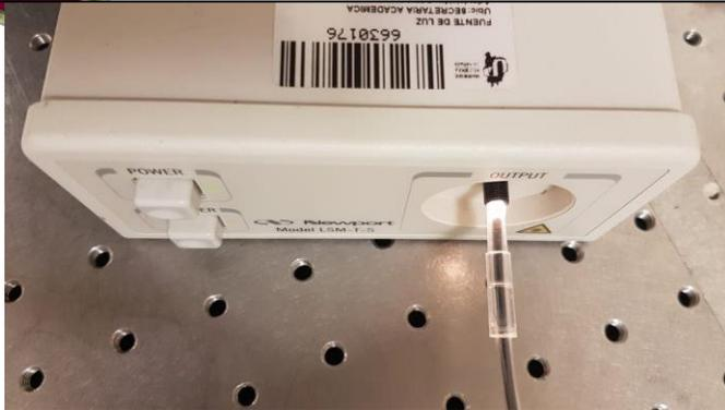
**Mini fuente de luz de Halógeno-Tungsteno de la marca Newport modelo SLM-T-S** con un rango espectral de 400-1100 nm y una apertura de 0.5 mm usada en mediciones de espectroscopia.
