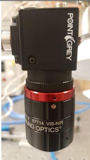
**Cámara monocromática marca Point Grey modelo FI3-U3-13S2C con lente de la marca Edmund Optics de 16 mm modelo M2514-MP2** con enfoque mecánico para la adquisición de imágenes a color con una resolución máxima de 1.3 mega píxeles y una profundidad máxima de 16 bits a 68 cuadros por segundo.
