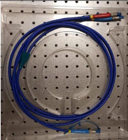
**Fibra óptica de la marca Ocean Optics modelo QP600-2-UV-VIS** con diámetro del núcleo de 600  $\mu\text{m}$  usada para la adquisición de espectros de reflexión difusa.
