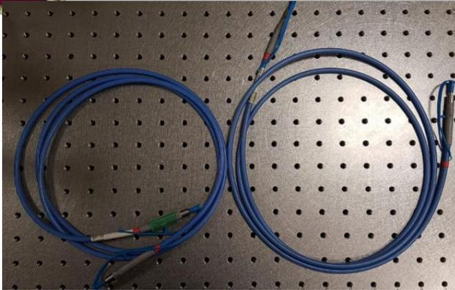
Fibras ópticas de la marca Ocean Optics modelo QP400-2-SR con diámetro del núcleo de  $400 \mu\text{m}$  usada para la adquisición de espectros ópticos de transmisión de luz.
