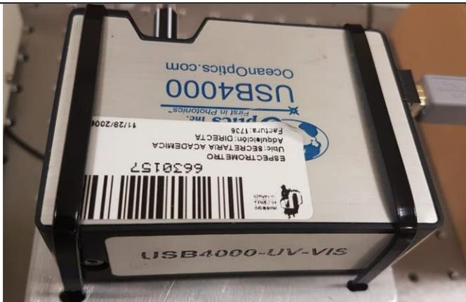
**Mini espectrómetro USB4000-UV-VIS** pre-configurado para mediciones generales de UV-Vis de 200-850 nm que incluye absorción, transmisión, reflectancia y emisión. Puede ser conectado a fuentes de luz, cubetas y otros accesorios. Alto rendimiento, con un tiempo de integración de 3.8 ms - 10 segundos, basado en fibra óptica.
