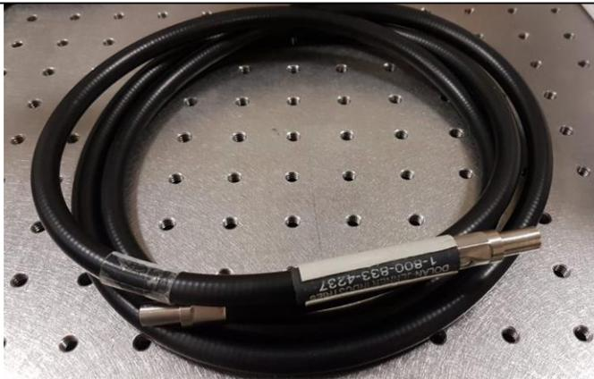
**Fibra óptica de la marca Dolan Jenner, modelo B472** con 6.3 mm de diámetro, usada como guía de luz en experimentos ópticos.
