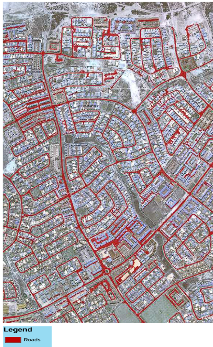
Figura 1.4: Delimitación de carreteras usando el índice de construcción de área. Imagen tomada de [24].
