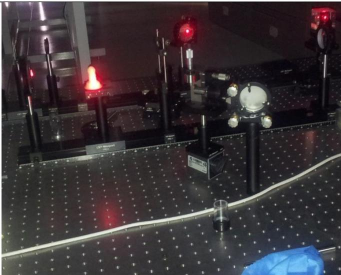
**Sistemas holográficos** para la medición de muy alta precisión de deformaciones en superficies.
