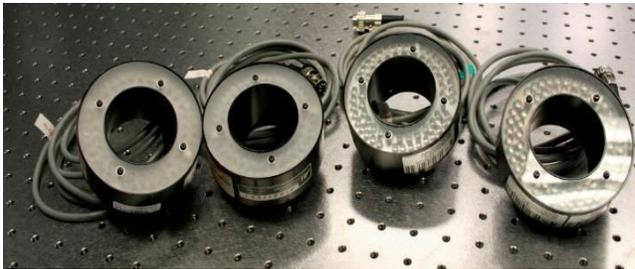
**Anillos de luz** que se utilizan para proporcionar una iluminación uniforme y radial alrededor de una lente de imagen para aplicaciones ópticas o de imagen. Las luces de anillo LED se montan alrededor de una lente de imagen, dirigiendo la luz hacia un objeto examinado. Las luces de anillo LED producen una luz uniforme, colocada directamente, que es ideal para reducir las sombras.
