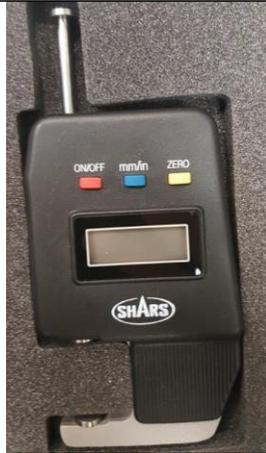
**Medidor de espesor** marca Shars. es una herramienta práctica y conveniente para medir el espesor. Es con alta precisión y pantalla digital LCD. Rango: 0-15 mm / 0-6 pulgadas Resolución: 0.01 mm.
