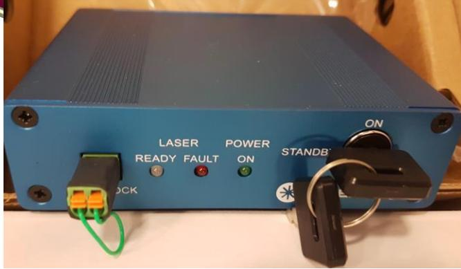
**Controlador para Láser BioRay.** Controlador láser con bloqueo de teclas CDRH compatible con los láser en diferentes longitudes de onda.
