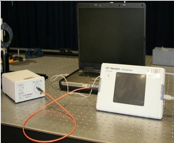
**Espectrómetro** en la región UV-Vis y en la región del infrarrojo medio de la compañía Newport utilizados para la caracterización de la absorción lineal de muestras tanto líquidas como sólidas en las regiones del espectro electromagnético ultravioleta, visible e infrarrojo medio.
