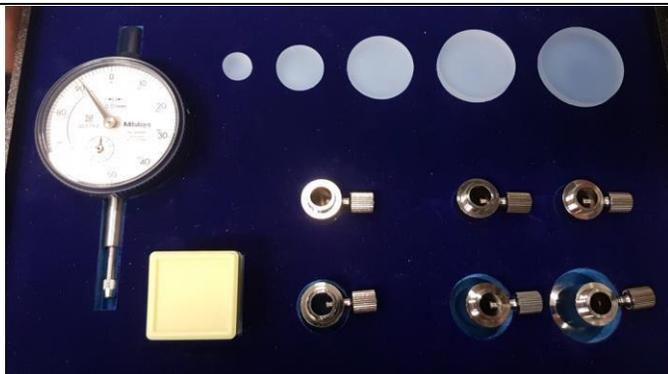
**Esferómetro óptico** de la marca Mitutoyo. El juego incluye seis cabezales de medición para medir radios de superficie que van desde 2.5 mm a 1000 mm. El diámetro de muestra más pequeño que se puede probar es un convexo de 4 mm o un cóncavo de 8 mm. El radio es una función del tamaño del cabezal de medición utilizado y la lectura del indicador de cuadrante.
