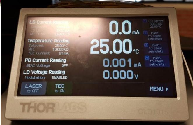
**Láser tipo mariposa** acoplado a fibra óptica que emite a una longitud de onda de 980 con su respectivo controlador de corriente y temperatura marca
