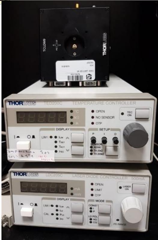
**Láser de estado sólido** con sus respectivos controladores de corriente y temperatura de la marca Thorlabs . Este láser emite con una longitud de onda de 532 nm y una potencia máxima de 100 mW.
