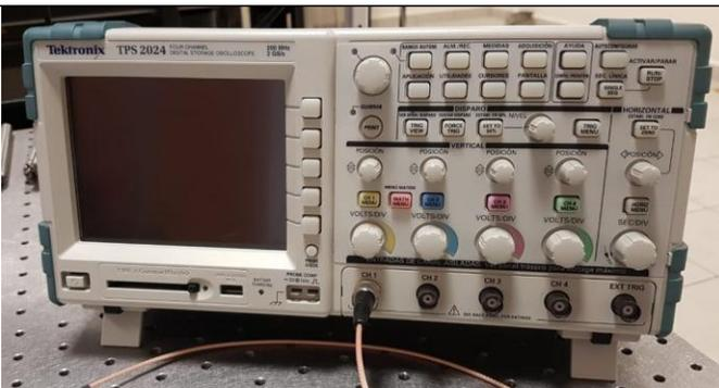
**Osciloscopio digital** modelo TPS 2024 de la compañía Tektronix usados para visualizar señales digitales y analógicas
