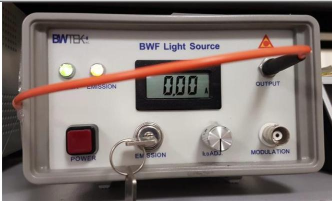
**Diodo láser** de estado sólido, con su respectivo controlador de corriente de la marca BWTEK que emite a una longitud de onda de 454 nm y una potencia máxima de 500 mW. Este láser está acoplado a una fibra óptica.
