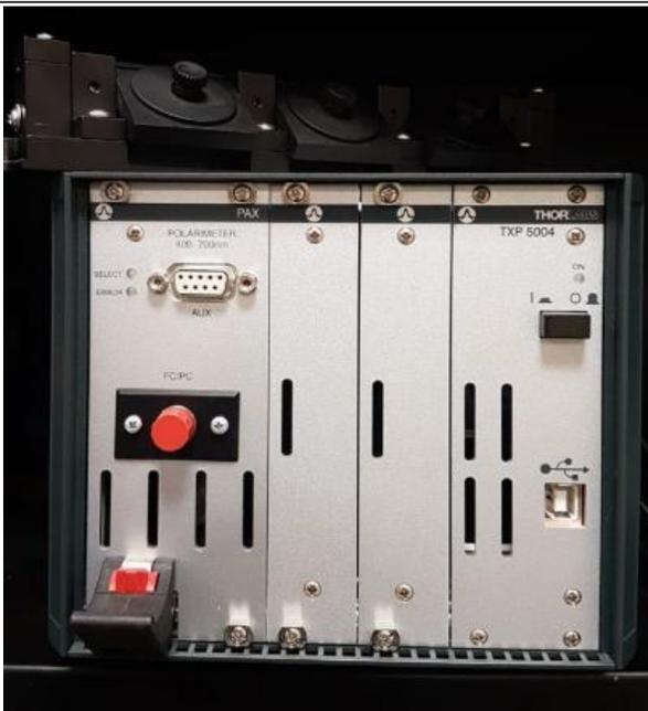
**Polarímetro** modelo TXP 5004 de la compañía Thorlabs. Trabaja en la región de los 400 a 700 nm y tiene una entrada FC. Es indispensable para conocer el estado de polarización de la luz que viaja a través de las fibras ópticas.
