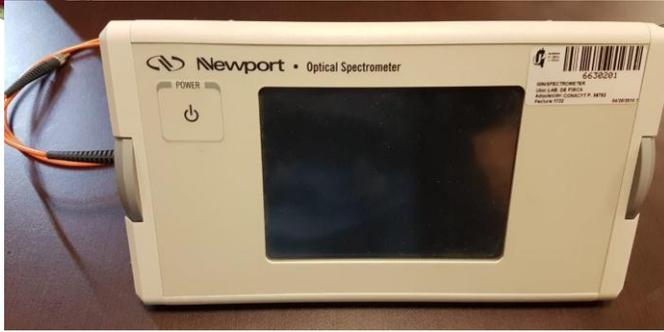
**Espectrómetro en la región UV-Vis** modelo OSM2-400 DUV-U de la compañía Newport utilizado para la caracterización de la absorción lineal de muestras tanto líquidas como sólidas en las regiones del espectro electromagnético ultravioleta y visible.
