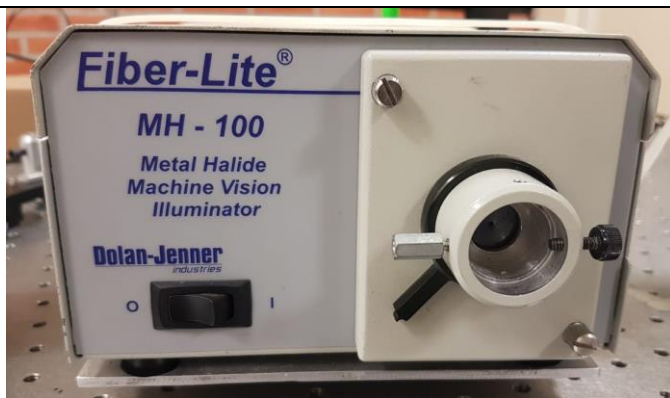
Fuente de luz marca Dolan Jenner modelo Fiber-Lite MH100 la cual es una fuente de mercurio con una emisión óptica de 3000 lumens, temperatura de color de 5200 k y un tiempo de vida de 3000 horas aprox.
