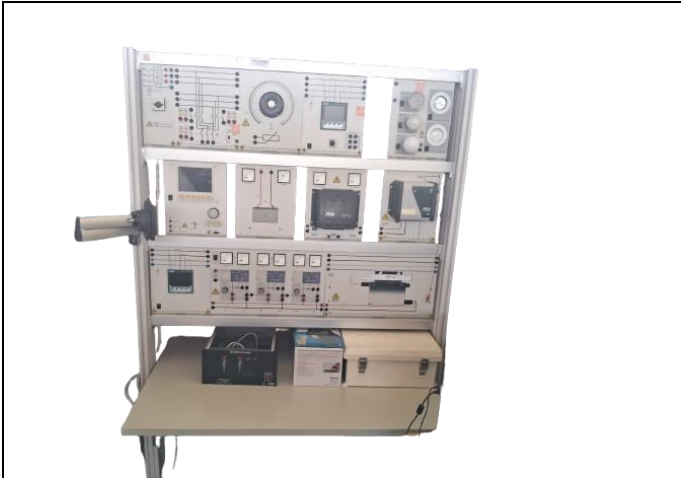
Rack de simulación de energía fotovoltaica, instalación de paneles solares, almacenamiento de energía eléctrica, adquisición y manejo de datos
