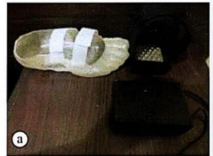
Figura 13. Prototipo experimental conformado por: 1 plantilla de latex natural, 1 fuente de iluminación (dispositivo con una matriz de LEDs rojos, con longitud de onda entre 635 y 640 nm, 1 molde hecho de alginato y agua [19].
