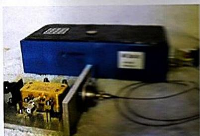
Figura 9. Dispositivo óptico: sección de entrada (inferior izq.) que incluye: láser, lente colimadora en la carcasa, polarizador lineal, modulador electroóptico de frecuencia variable, acoplador de fibra y fibra óptica de mantenimiento de la polarización; (superior derec.) prototipo completo de 12 elementos del conjunto de sensores de tensión de pie y conjunto del cable del detector [14].
