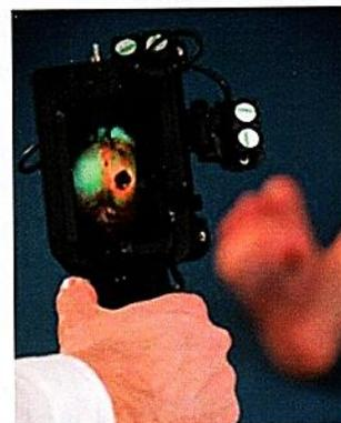
Figura 11. Dispositivo de imágenes de auto fluorescencia PRODIGI (Detección óptico portátil en tiempo real, identificación y orientación para la Intervención) [17].
